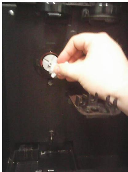
10) Jakmile stroj po umytí vyschne, vložíme do něj zpět vnitřní části stroje a to tak jak jsme je postupně vyjmali. Pouze v případě pressovací jednotky je nutno nastavit pohon jednotky do polohy jako na obrázku a to tak, že budeme ojkou pohonu pohybovat ve směru hodinových ručiček.
